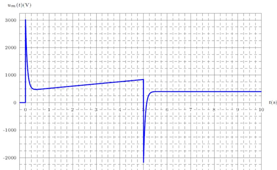
Figure 15 : Evolution de la tension moteur soumise à une consigne en trapèze de vitesse.
