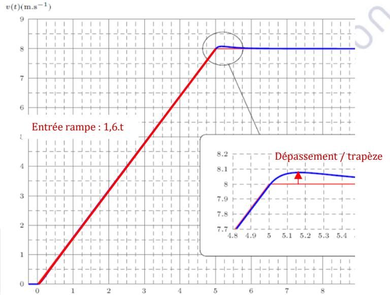
Figure 14 : Réponse à un trapèze de vitesse avec  $V_0 = 8 \text{ m.s}^{-1}$  et accélération
