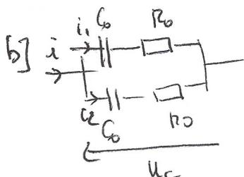
$$\begin{cases} i = i_1 + i_2 \\ \frac{du_c}{dt} = \frac{i_1}{C_0} + R_0 \frac{di_1}{dt} = \frac{i_2}{C_0} + R_0 \frac{di_2}{dt} \end{cases}$$
