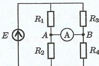
L'ampèremètre est modélisable par une résistance  $r$ . On dit que le pont est équilibré lorsque le courant traversant l'ampèremètre est nul.
