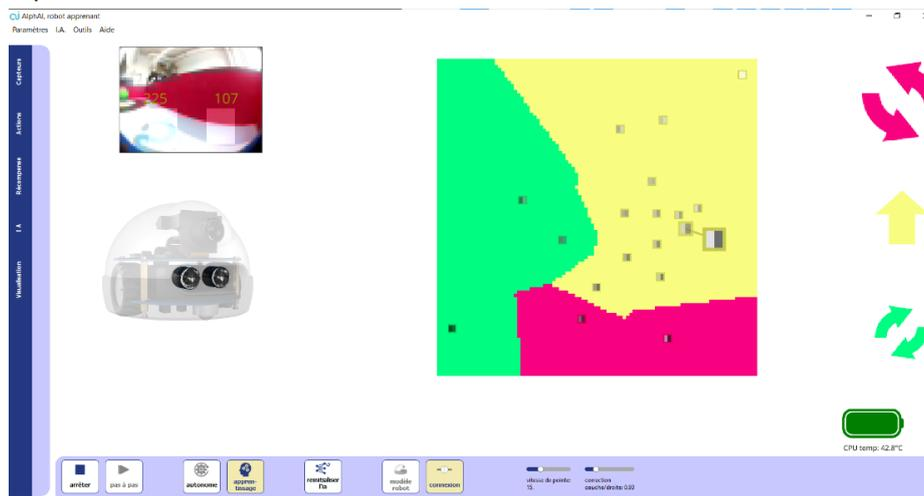
La luminosité diminue lorsque le robot s'approche des murs. Normalement, si la zone de gauche est la plus sombre, il faut tourner à droite, et inversement.
