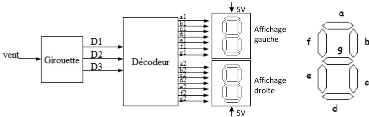
L'objectif est de déterminer le décodeur qui sert d'interface entre la mesure de la direction et l'affichage. On désire afficher les informations suivantes :
