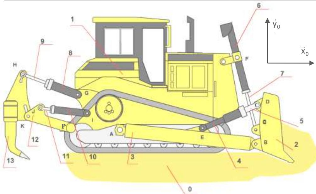
La lame 2 est rattachée au bulldozer 1 par l'intermédiaire de la pièce 3 ainsi que les deux vérins 7+6 et 5+4. La griffe 13 est rattachée au bulldozer par l'intermédiaire de la pièce 12 et du vérin 8+9. Les liaisons aux points A, B, C, D, E, F, G, H, I et J sont des liaisons pivot parfaite suivant l'axe  $\vec{z}_0$ . La pièce 12 est reliée à la griffe 13 au point K grâce à une rainure. Tous les vérins ont une surface de piston identique de  $2500.\pi \text{ mm}^2$ .
