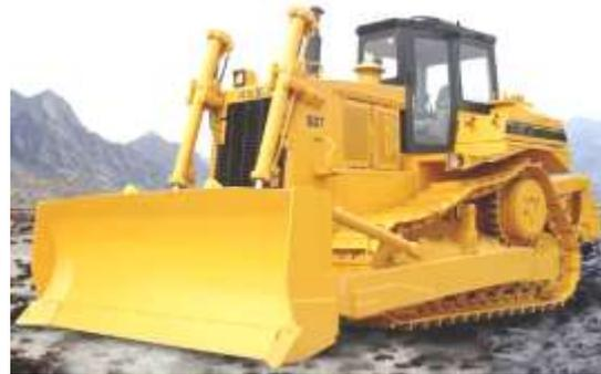
L'objectif de cette étude est de déterminer toutes les actions mécaniques agissant sur les vérins hydrauliques qui actionnent la lame et griffe afin de vérifier une performance du bulldozer dont on donne un extrait partiel du cahier des charges fonctionnel.
