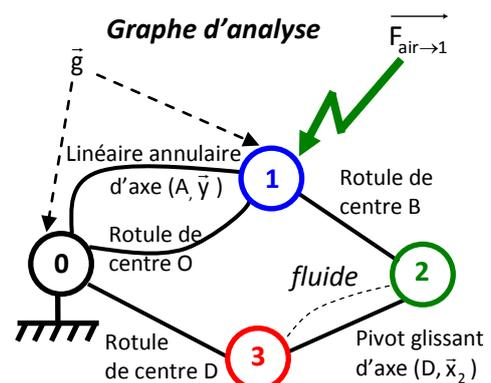
**Q.3.** On isole l'ensemble 2+3 et on effectue le B.A.M.E. :
