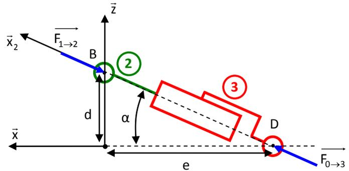
D'où :  $\{F_{1 \rightarrow 2}\}_B = \begin{Bmatrix} \vec{F}_{1 \rightarrow 2} = -p.S.\vec{x}_2 \\ \vec{0} \end{Bmatrix} = \begin{Bmatrix} X_{1 \rightarrow 2} & 0 \\ 0 & 0 \\ Z_{1 \rightarrow 2} & 0 \end{Bmatrix}_{(\vec{x}, \vec{y}, \vec{z})}$  où  $X_{1 \rightarrow 2} = -p.S.\cos \alpha$  et  $Y_{1 \rightarrow 2} = -p.S.\sin \alpha$
