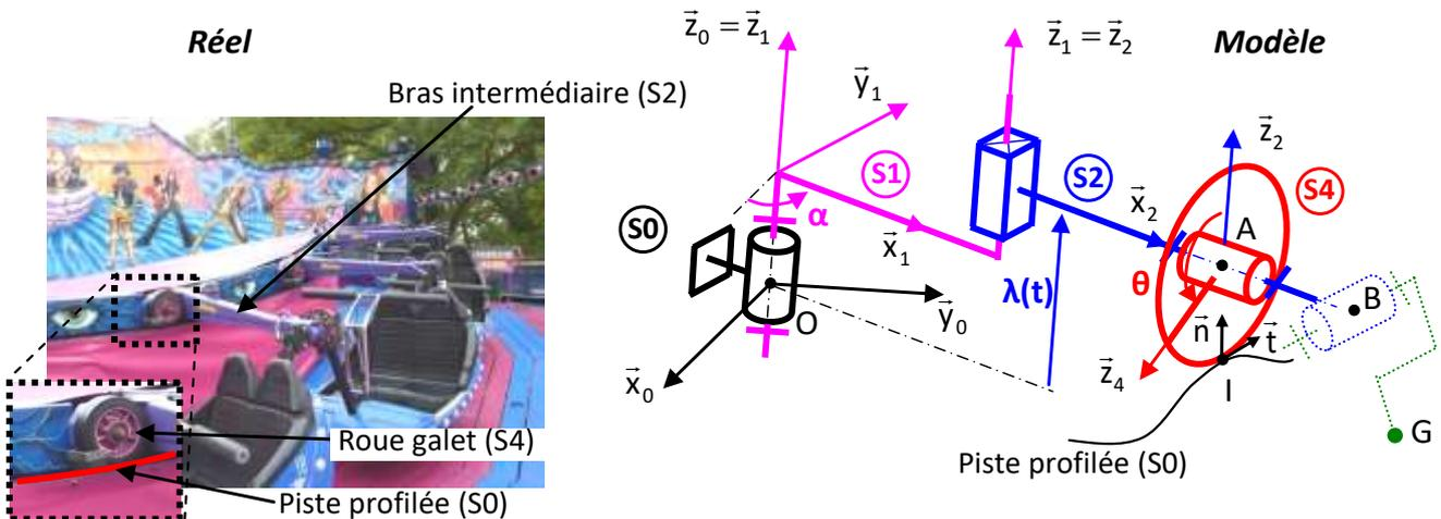
La roue (S4) est en liaison pivot autour de l'axe  $(A, \vec{x}_2)$  avec le bras (S2) et roule sur la piste au point de contact noté I. On note  $\theta = (\vec{z}_2, \vec{z}_4) = (\vec{y}_2, \vec{y}_4)$  l'angle de rotation de la roue.
