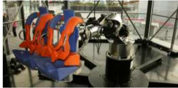
Le système est principalement constitué d'un robot 6 axes, d'une armoire de gestion permettant le pilotage du robot, d'une plate forme d'accès mobile permettant l'embarquement ou le débarquement des passagers, d'une grille de protection accompagnée de nombreux dispositifs de sécurité et d'une armoire de commande générale de l'installation.
