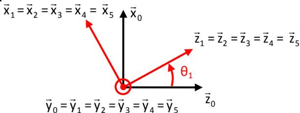
$$\vec{V}_{P \in 6/0} = \frac{d}{dt} \vec{O_0 P} \Big|_0 = \frac{d}{dt} \vec{O_0 O_1} + \vec{O_1 O_2} + \vec{O_2 O_3} + \vec{O_3 O_4} + \vec{O_4 O_5} + \vec{O_4 P} \Big|_0 = \frac{d}{dt} a_1 \cdot \vec{x}_1 + b_1 \cdot \vec{y}_1 + a_2 \cdot \vec{x}_2 + a_3 \cdot \vec{x}_3 + a_4 \cdot \vec{x}_3 + a_5 \cdot \vec{x}_5 + a_6 \cdot \vec{x}_5 \Big|_0$$
