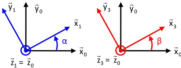
Fermeture géométrique :  $\vec{CC} = \vec{CA} + \vec{AB} + \vec{BC} = \lambda(t) \cdot \vec{y}_1 - L \cdot \vec{y}_3 - H \cdot \vec{y}_0 = \vec{0}$
