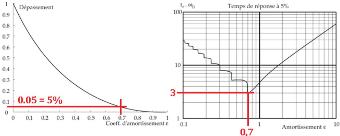
**Q12. En déduire la valeur de  $K_{cor}$  correspondante et déterminer le dépassement et le temps de réponse à 5% du système avec ce réglage.**
