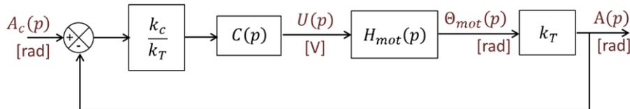
Ce qui permet de retrouver le schéma de l'énoncé en posant :  $K_U = \frac{k_c}{k_t}$  et  $H(p) = H_{mot}(p) \cdot k_T$
