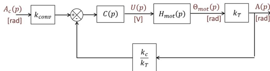
La contrainte à imposer pour que l'erreur soit proportionnelle à l'écart est donc  $k_{conv} = k_c/k_T$ , ce qui permet d'obtenir le schéma bloc à retour unitaire suivant :
