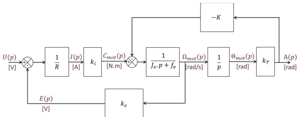
Le système décrit par ce schéma bloc ne comporte pas de capteur mesurant la position réelle du siège pour la comparer à une consigne. Il fonctionne donc avec une commande en boucle ouverte, ce n'est pas un système asservi.
