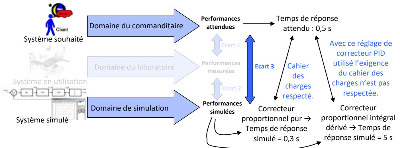
Résultats obtenus avec un logiciel de simulation (gratuit) : Easy Reg
