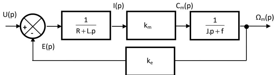
Si on utilise un correcteur proportionnel, l'application numérique des grandeurs physiques permet de trouver la fonction de transfert simplifiée suivante :  $\frac{\Omega_v(p)}{\Omega_c(p)} = \frac{K_T}{1 + T_T.p}$ , avec  $K_T=0,9$  et  $T_T=0,1s$
