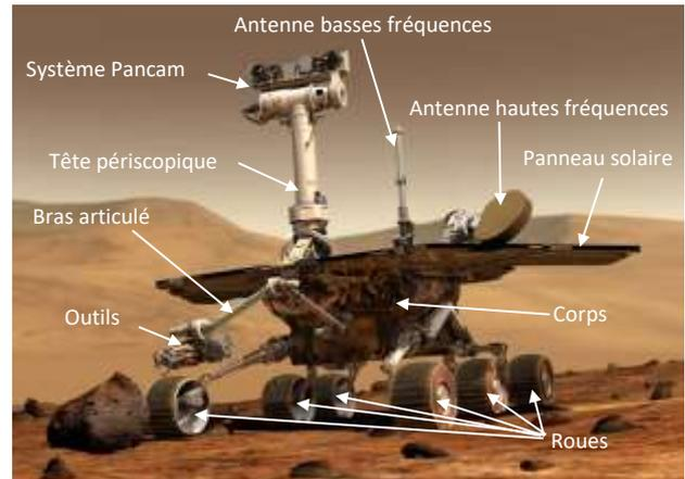
Pour faire avancer le robot, les six roues de Spirit sont équipées de motoréducteurs (le motoréducteur est un composant constitué d'un moteur, qui génère un mouvement de rotation, et d'un réducteur, qui réduit la vitesse de rotation du moteur par des engrenages) afin de faire tourner les roues. Le codeur incrémental permet de mesurer la rotation du moteur.
