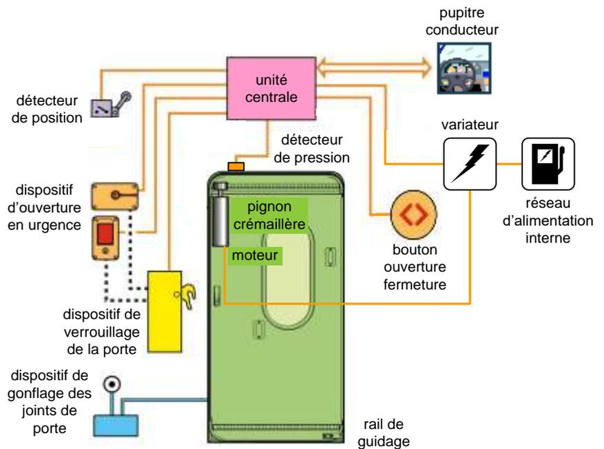
Afin de satisfaire les contraintes d'encombrement, l'ouverture de la porte s'effectue selon l'enchaînement temporel de trois phases distinctes décrites à partir de la position « porte fermée » pour laquelle la face extérieure de la porte est alignée avec la face extérieure de la caisse : une phase de décalage puis une phase de louvoiement et enfin une phase d'escamotage. La phase primaire (décalage) puis la phase terminale (escamotage) sont définies par les figures ci-contre.
