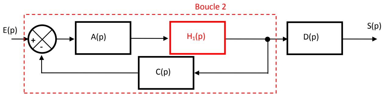
$$\text{Calcul de la FBTF de la boucle 2 : } H_2(p) = \frac{1}{C(p)} \cdot \frac{A(p) \cdot C(p) \cdot H_1(p)}{1 + A(p) \cdot C(p) \cdot H_1(p)} = \frac{A(p) \cdot \frac{B(p)}{1 + B(p) \cdot D(p) \cdot E(p)}}{1 + A(p) \cdot C(p) \cdot \frac{B(p)}{1 + B(p) \cdot D(p) \cdot E(p)}}$$
