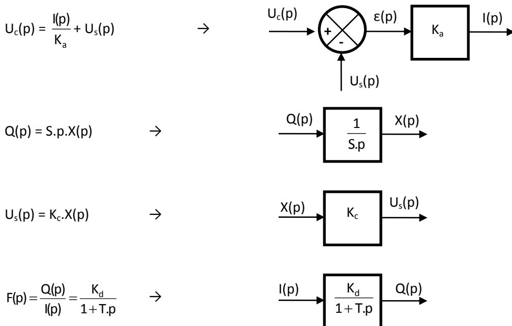
**Q1.3.** Regrouper les schémas-blocs partiels afin de représenter le comportement de la servocommande.
