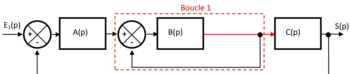
$$\text{Calcul de la FBTF de la boucle 1 : } H_1(p) = \frac{B(p)}{1 + B(p)}$$
