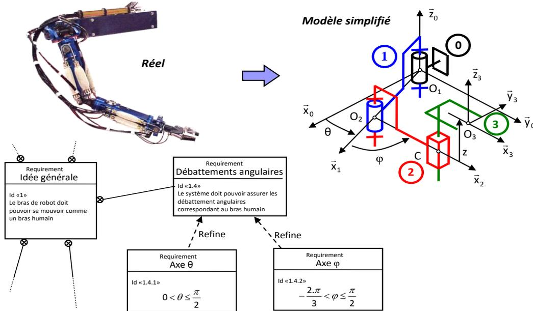
Pour déterminer le couple moteur  $C_1$ , il faut isoler l'ensemble  $E = 1+2+3$  et utiliser le théorème du moment dynamique écrit au point  $O_1$  projeté sur l'axe  $\vec{z}_0$ . Ce choix permet d'obtenir une équation scalaire où aucune inconnue de liaison n'intervient puisqu'elle correspond au 0 du torseur d'action mécanique transmissible.
