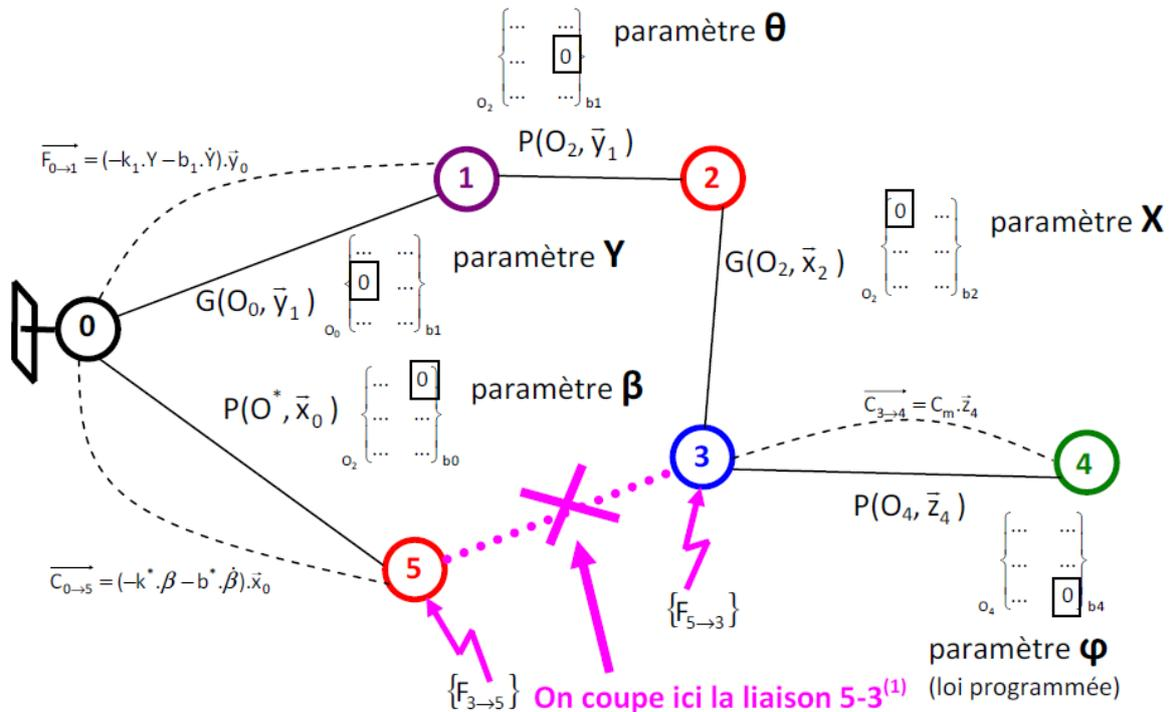
On injecte par conséquent 3 inconnues de liaisons supplémentaires dans le système d'équation qui permettra d'obtenir les lois du mouvement → Soit un total de 8 équations à trouver.
