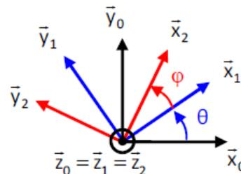
$$\vec{\sigma}_{O_1, 2/0} = l \cdot (\dot{\theta} + \dot{\phi}) \cdot \vec{z}_0 + m \cdot L^2 \cdot \dot{\theta} \cdot \vec{z}_0 + m \cdot \frac{L^2}{2} \cdot (\dot{\theta} + \dot{\phi}) \cdot$$
