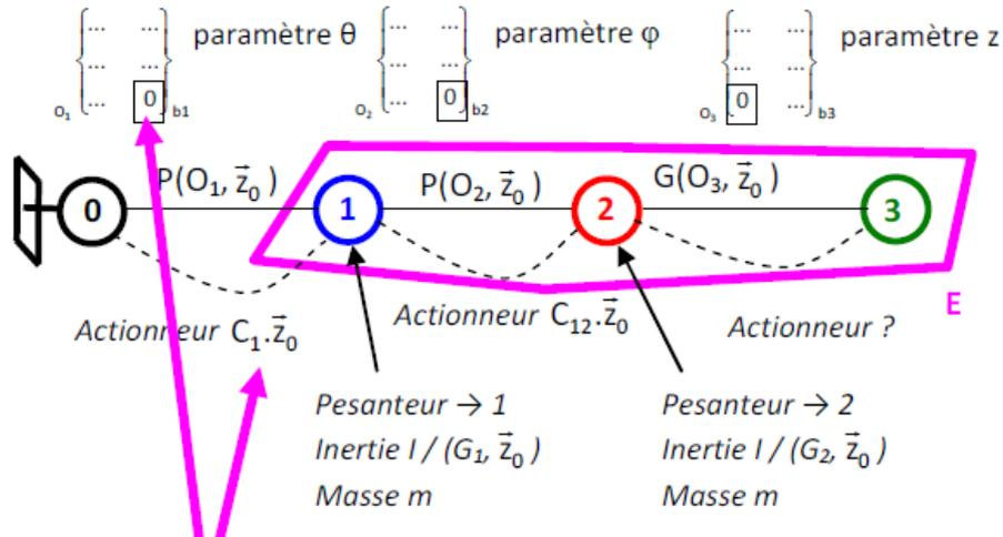
Pour déterminer le couple moteur  $C_1$ , il faut isoler l'ensemble  $E = 1+2+3$  et utiliser le théorème du moment dynamique écrit au point  $O_1$  projeté sur l'axe  $\vec{z}_0$ . Ce choix permet d'obtenir une équation scalaire où aucune inconnue de liaison n'intervient puisqu'elle correspond au 0 du torseur d'action mécanique transmissible.
