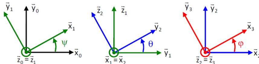
Le modèle possède 3 paramètres cinématiques :  $\psi$ ,  $\theta$  et  $\phi$ . Il existe une condition liée à la loi horaire :  $\dot{\phi} = \Omega = cte$
