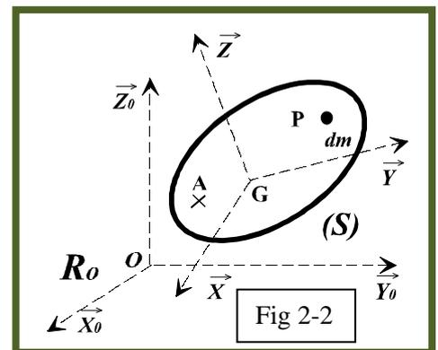
L'énergie cinétique du solide (*S*) dans son mouvement par rapport au repère *R*<sub>0</sub> se calcule par le demi commoment du torseur cinématique et du torseur cinétique, tous deux étant exprimés en un même point *A*.
