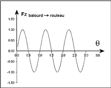
$$F_{Z_{balourd} \rightarrow rouleau} = M_b \cdot e \cdot (\omega_b)^2 \cdot \cos(\theta) \quad (\text{projection sur } Z_0 \text{ de l'action « centrifuge » } F_c)$$
