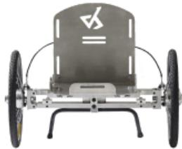
Il est équipé d'un système de suspension permettant de limiter le mouvement de roulis dans les virages.
