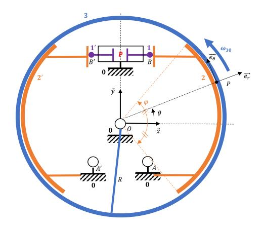
Question 1: Déterminer l'effort presseur  $\vec{F}$  au contact ponctuel en B entre 1 et 2 en fonction de r et p en partant du principe que l'effort issu de la pression sur le piston se transmet intégralement à ce contact
