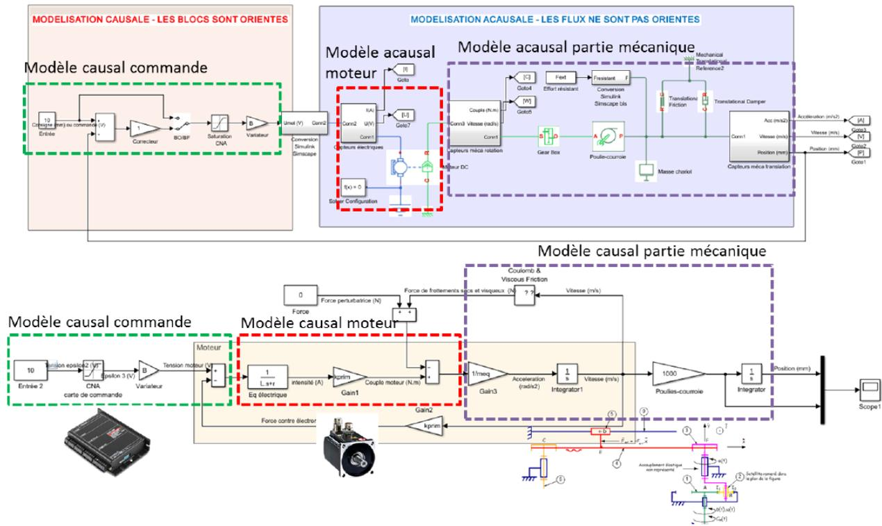
Visuellement on constate que sur le modèle causal, les composants du système apparaissent. Ainsi, sans connaître les lois de comportements des composants, il est possible de réaliser le modèle multiphysique d'un système.
