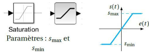
Tout d'abord, dans les systèmes asservis et corrigés, le correcteur permet souvent une amplification de la consigne. Par exemple, un correcteur proportionnel de valeur 5 dans la boucle ouverte permet de multiplier par 5 la tension de commande. Celle-ci peut alors être supérieure à la tension que la source peut fournir.
