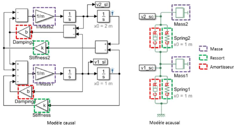
Modélisation causale et acausale d'un système avec deux systèmes « masse – ressort – amortisseur » en série.
