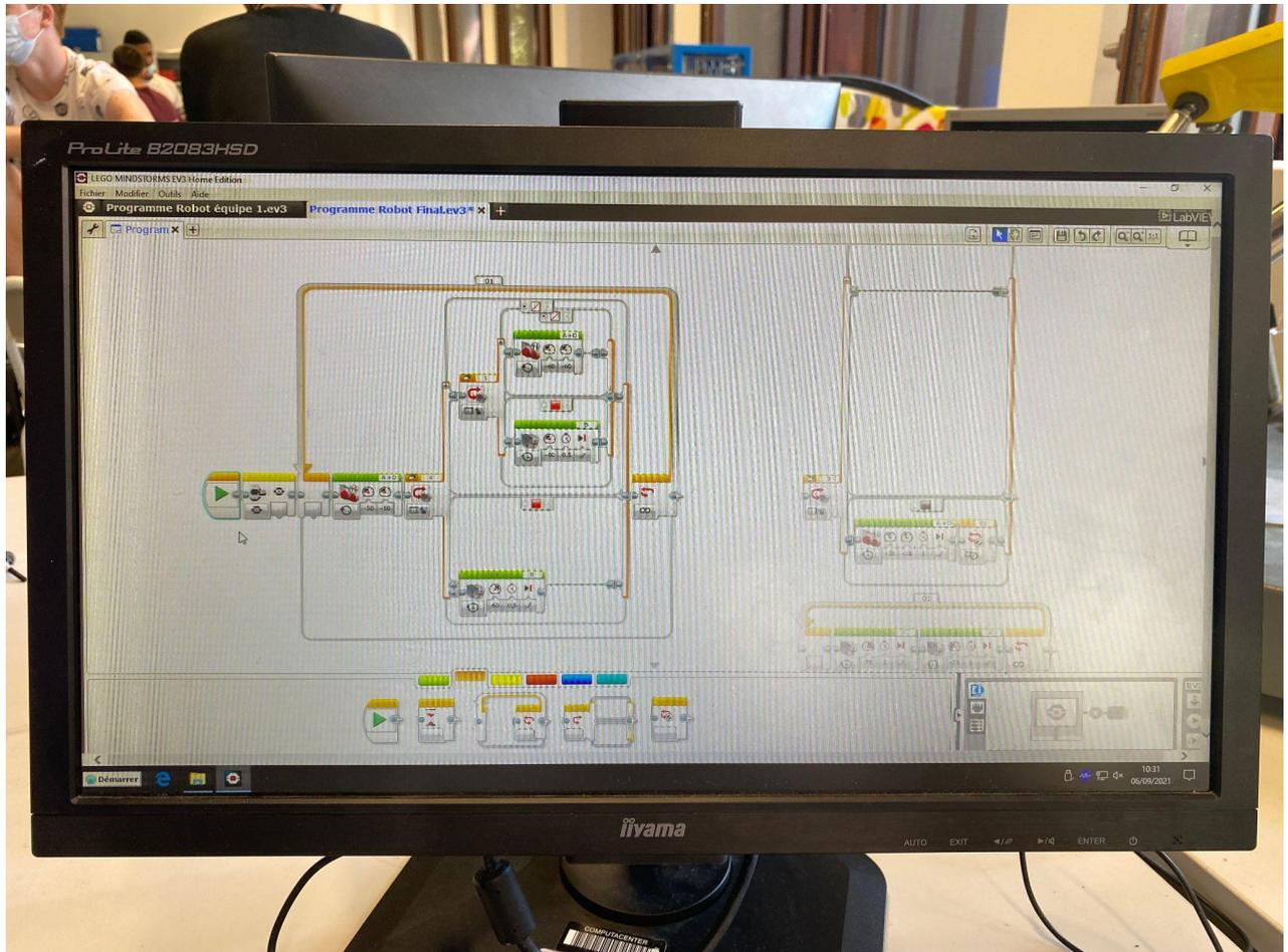
Nous avons ajouté des boucles et blocs de programmation (boucle infinie, module déplacement char, etc...) et enfin séparé les programmes qui gèrent la propulsion (2 gros moteurs) et la direction (1 moteur moyen). Il était difficile de réussir à programmer à la fois la rotation et l'avancée du véhicule.
