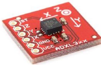
FIGURE 1 – Accéléromètre miniature
