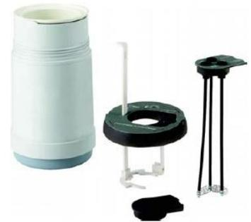
Pour effectuer les mesures de température, le calorimètre peut s'utiliser avec un thermomètre à dilatation en verre assez long, une sonde de température de diamètre inférieur à 7 mm
