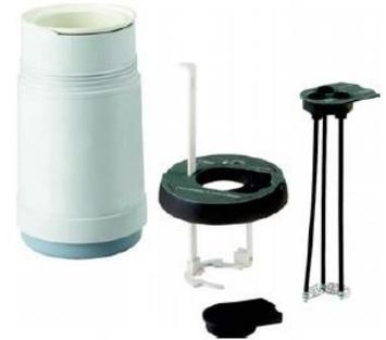
Pour effectuer les mesures de température, le calorimètre peut s'utiliser avec un thermomètre à dilatation en verre assez long, une sonde de température de diamètre inférieur à 7 mm
