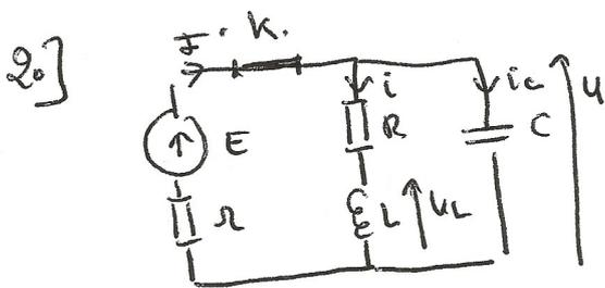
$$\begin{cases} E = rI + u & (1) \text{ équations du circuit.} \\ \bar{q} = i + ic & (2) \\ u = Ri + L \frac{di}{dt} & (3) \\ ic = C \frac{du}{dt} & (4) \end{cases}$$
