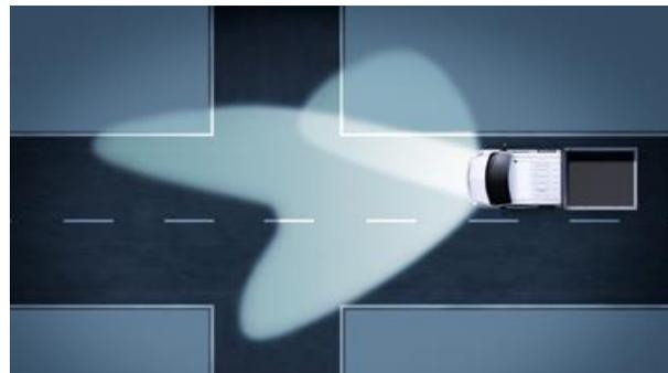
L'éclairage statique d'intersection consiste à allumer le phare antibrouillard du côté où le véhicule tourne. La commande de cet allumage dépend donc de l'angle de rotation du volant mais aussi de la vitesse du véhicule car cette fonctionnalité est limitée aux déplacements à faible vitesse (inférieur ou égal 40 km/h).
