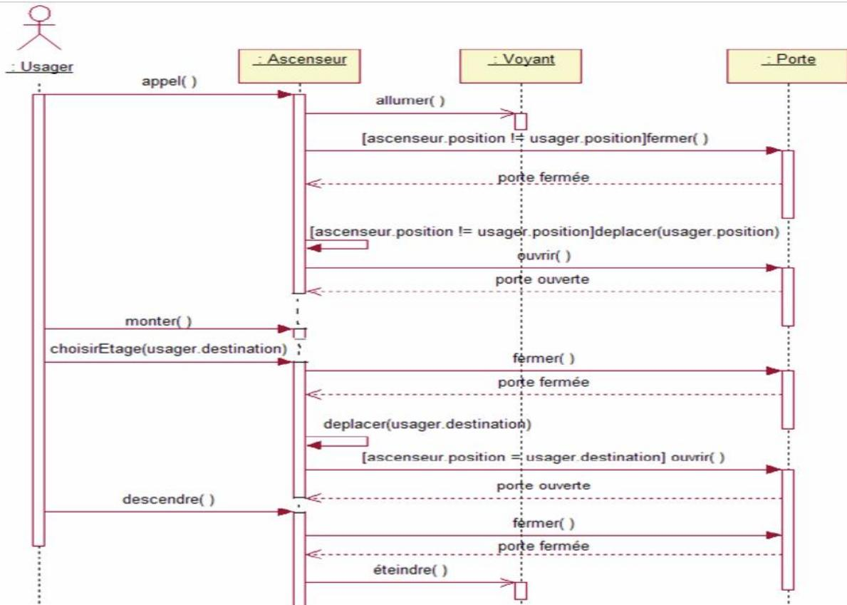
Le schéma suivant permet de définir les entrées sorties du controleurAscenseur
